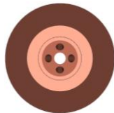
Plasmadüse mit 4x Pulverbohrung (90°)
